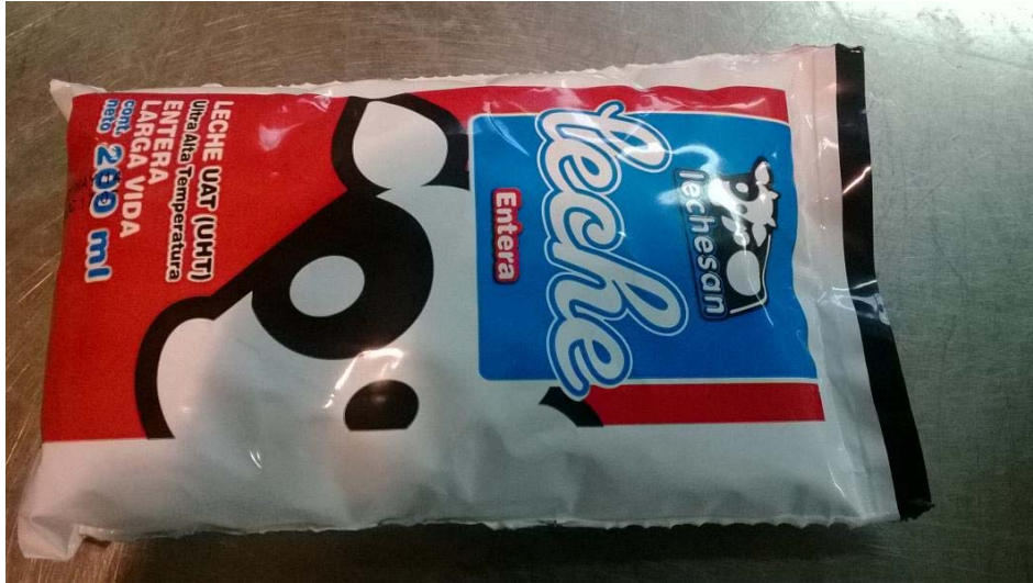
Figura 36. Desalineación en la unidad empacada.
