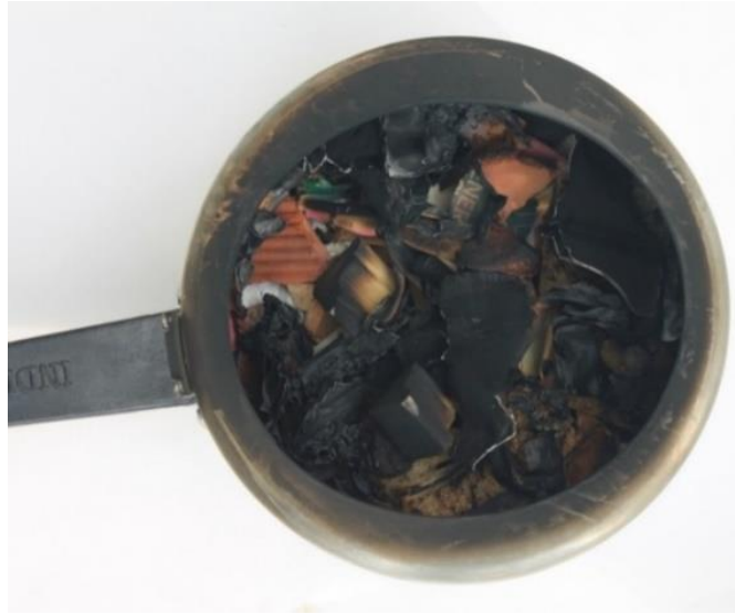
Figura 11. Residuos de un incendio acelerado con gasolina.
