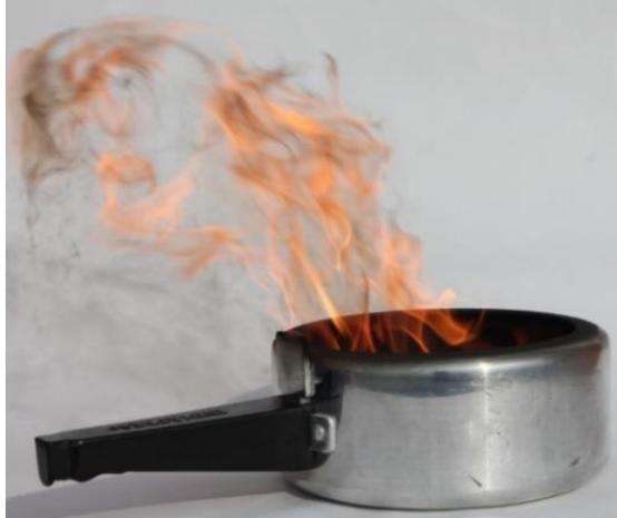
Figura 10. Incendio de la matriz provocado con gasolina.
