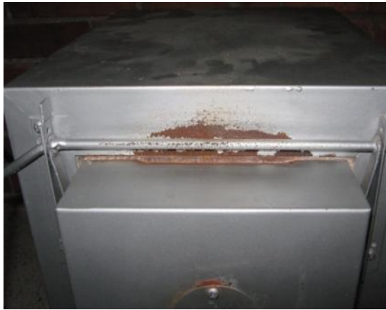
PRESENCIA DE OXIDO CARA FRONTAL
