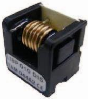
Figura 31 SENSOR DE CORRIENTE L18P020D15 BASADO EN EFECTO HALL
