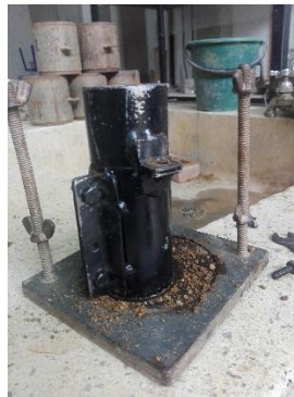
Figura 11. Molde de compactación
