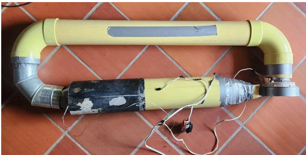
Figura 10. Sistema prueba de eficiencia energética, recirculación de aire.
