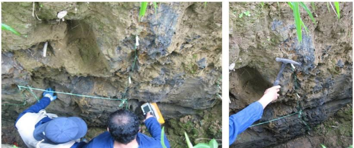
Figura 25. Trinchera Tb9 indicando rejilla (cuerda color verde) para detallar el micropliegue y medidas de radiometría. Detalle a la (izquierda) del nivel muestreado para petrografía.
