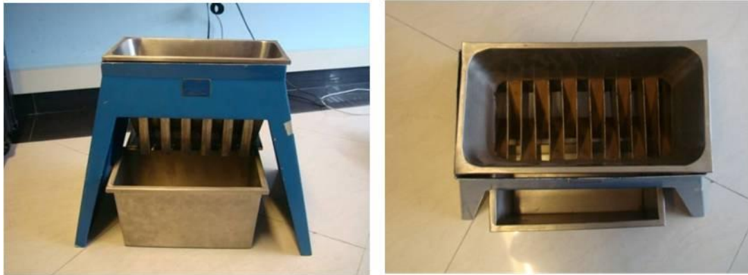
Figura 9. Cuarteador o separador visto de lado y desde arriba. El material que se vierte sobre la bandeja superior se divide en 2 bandejas.
