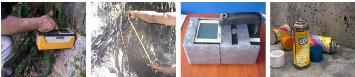
Figura 4. Elementos necesarios para marcar intervalos radiométricos.
