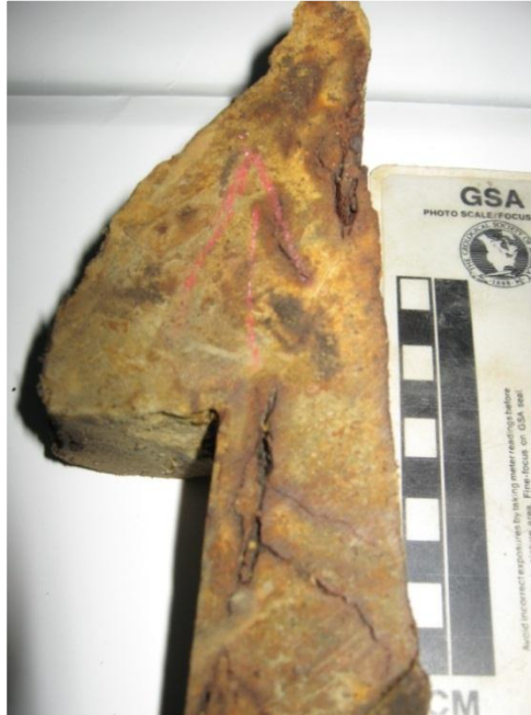
Figura No. 2. Arenisca fosfática de grano muy fino. La flecha indica la polaridad de la secuencia. Costras de óxidos en los planos de debilidad.
