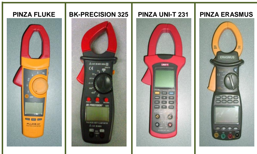
Figura 45: Pinzas para medición de variables eléctricas
