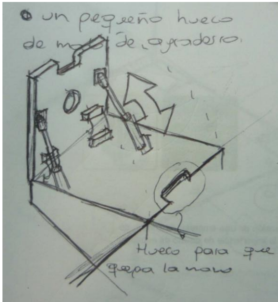
Figura 28. Evolución sistema de instalación lavamanos (vessel y empotrar)
