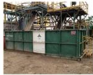
Catch Tank para recibir solidos descartados por la centrifuga.
