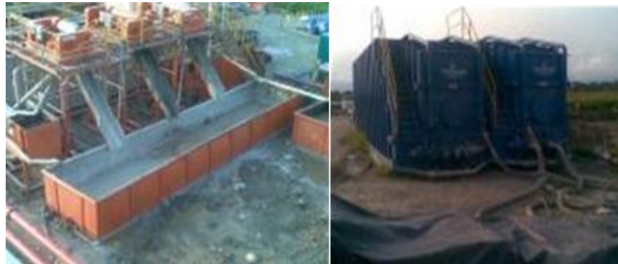
Figura 8. Stand con centrifugas y Frac Tanks
