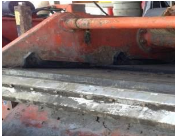
Figura 40. Cuñas ajustando mallas
