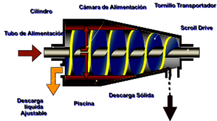
Figura 56. Esquema funcionamiento centrifuga decantadora
