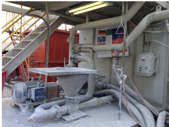
Figura 27. Embudo de los tanques de succión.
