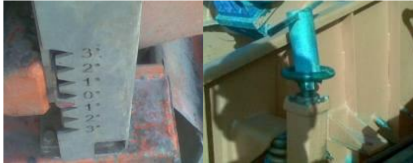
Figura 35. Sistema de inclinación zaranda y herramienta hechiza para inclinación
