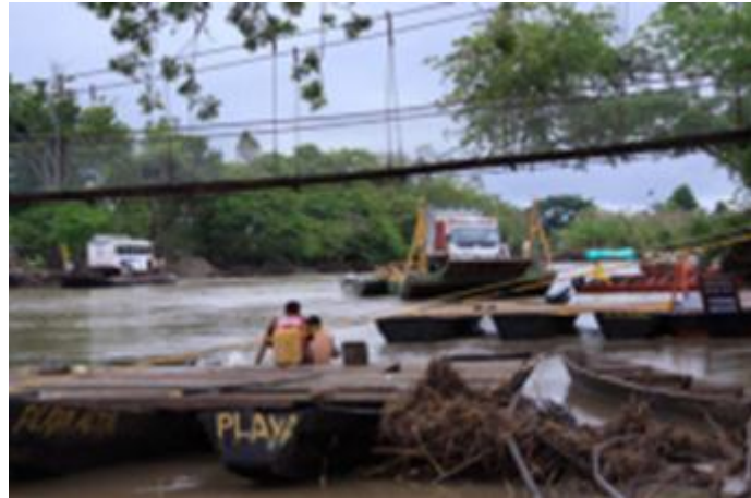
Figura 4. Ferri armado con Chalupas
