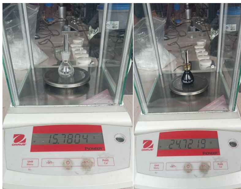
Figura 8. Medición de la densidad a través de método del Picnómetro
