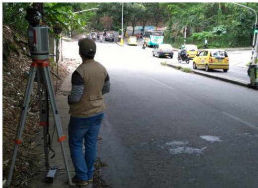
Figura 7. Levantamiento topográfico con el escaner
