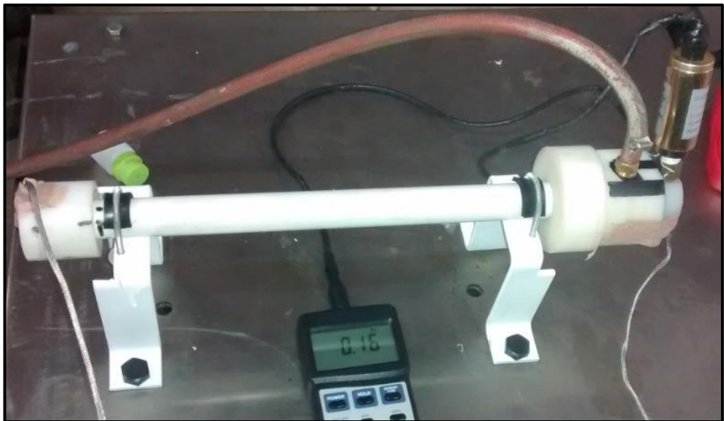
FIGURA 43. Tubo vórtice y soporte
