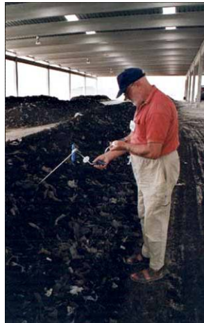
Figura 1. Control de parámetros mediante sensores
