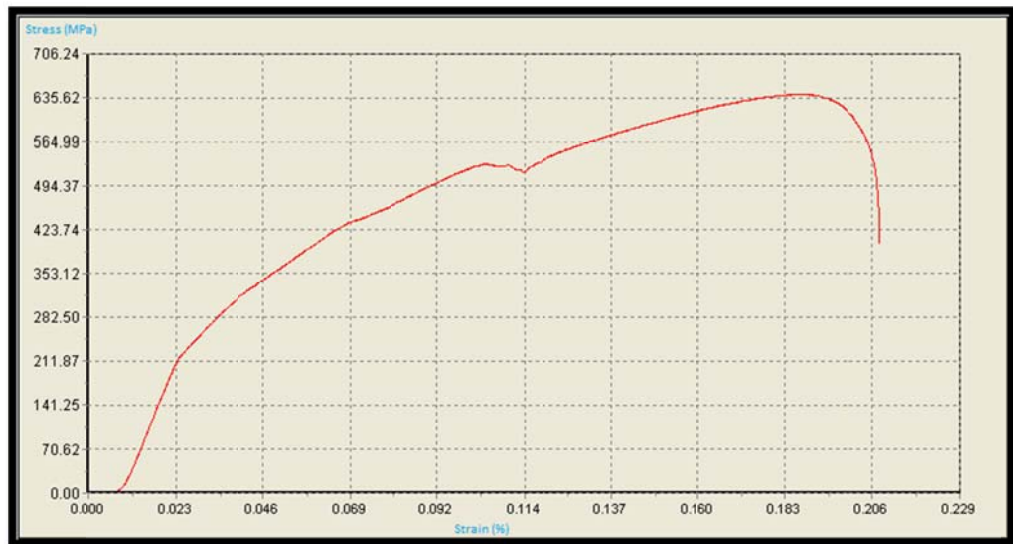
Grafica 4. Curva esfuerzo deformación, probeta hidrogenada 24 horas
