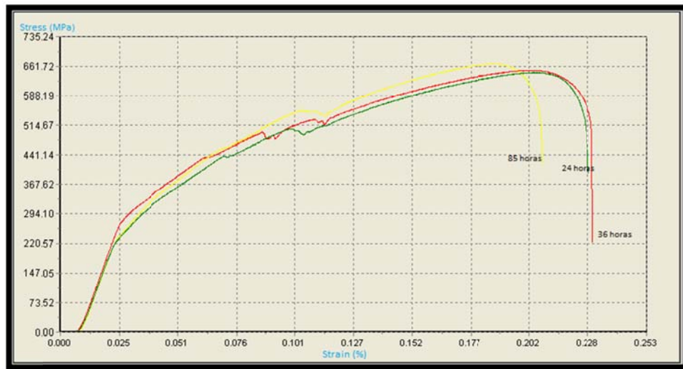
Grafica 8. Esfuerzo vs tiempo de hidrogenación
