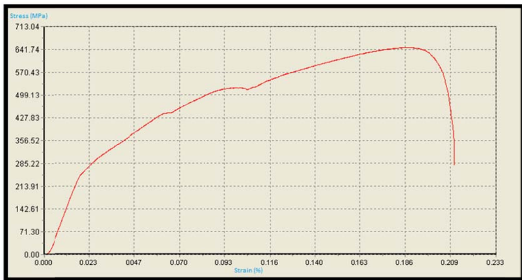
Grafica 3. Curva esfuerzo deformación probeta blanco
