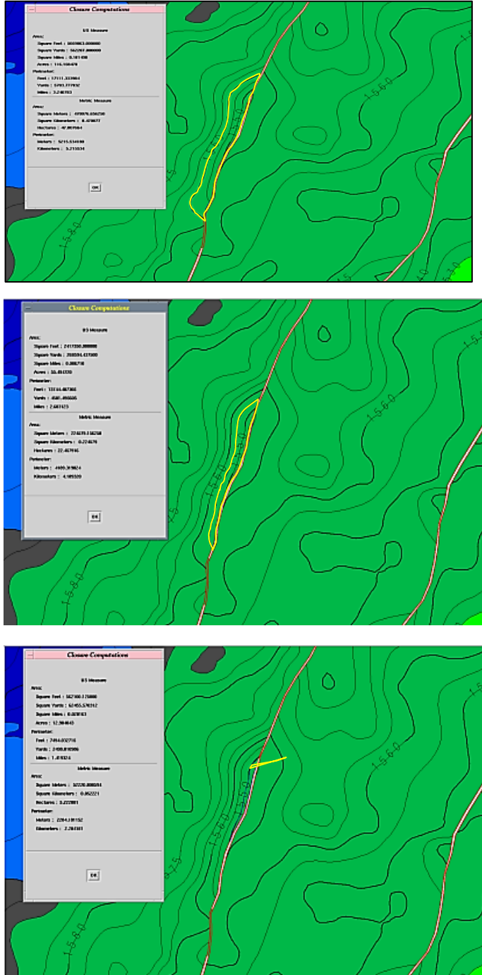
Figura 26. Recálculo de áreas sobre el mapa de contornos desarrollado en SeisWorks® importado desde Z-Map Plus® como archivo ZGF, para los tres contornos de cierre de la estructura.
