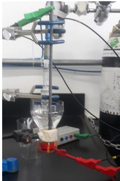
Figura 38. Montaje experimental de la celda electroquímica usada.
