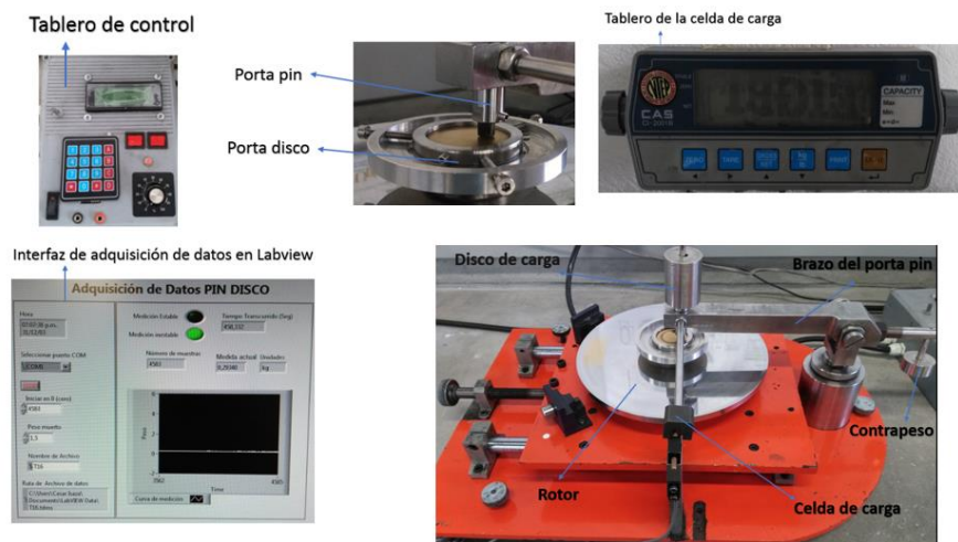
Figura 35. Partes del tribómetro pin sobre disco
