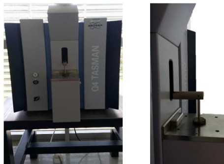
Figura 31. Espectrómetro de emisión óptica Q4 Tasman
