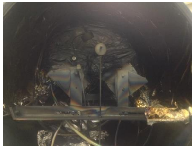
Figura 24. Interior de la cámara de vacío
