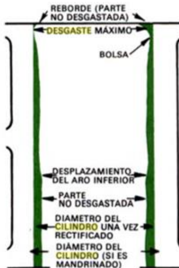
Figura 3. Desgaste cónico de un cilindro de motor
