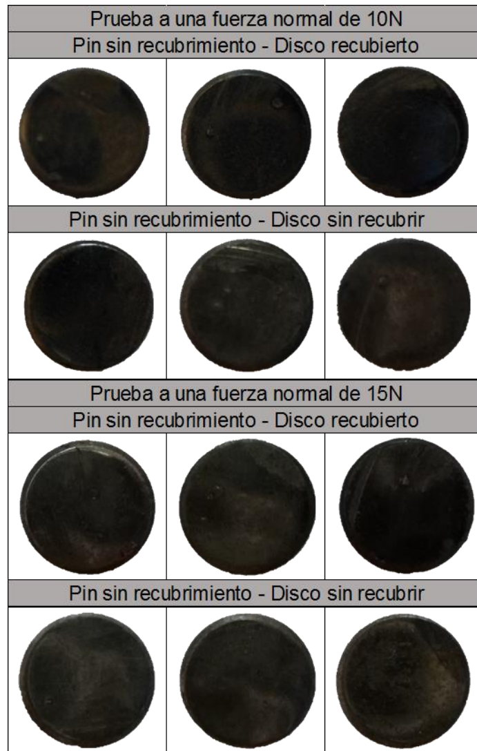
Figura 42. Superficie de los pines sin recubrimiento después del ensayo de desgaste
