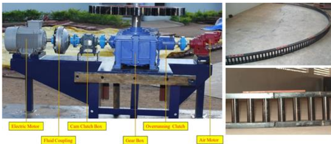
Figura 6. Componentes del sistema de transmisión.
