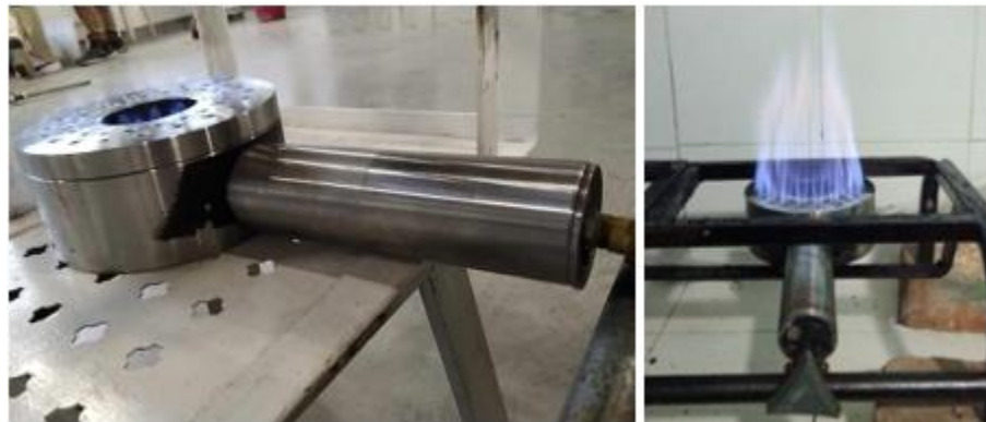
Figura 34. Quemador fabricado usando a la derecha gas natural y a la izquierda biogás
