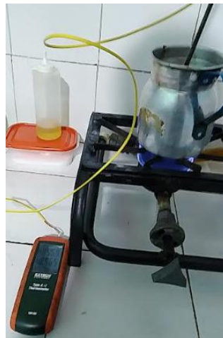
Figura 32. Medición de la temperatura del agua calentada con biogás
