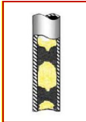
Figura 30. Régimen tipo flujo Slug.
