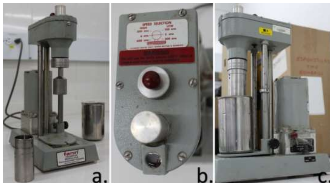
Figura 14 Medida viscosidad a. viscosímetro FANN modelo 35 a , b. Parte superior donde se selecciona el dial de velocidades a trabajar c. vista lateral viscosímetro FANN modelo 35 a armado, botón de encendido parte inferior derecha de la imagen.
