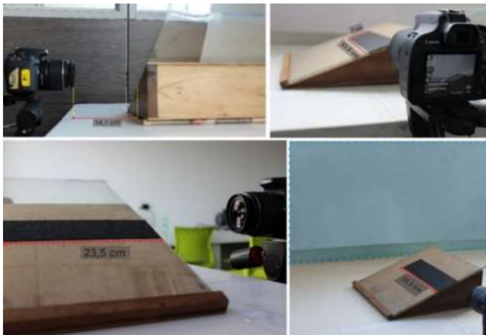
Figura 18. Montaje experimental. Se constituye principalmente de una cámara modelo Canon EOS REBEL T5 ISO-3200 con el foco a una distancia de 14,1 cm del modelo (Ver imagen superior izquierda), en el modo ráfaga de 3 fotos por segundo (Ver imagen superior derecha) y acondicionado con fondo blanco (imagen inferior derecha, resaltado con azul).
