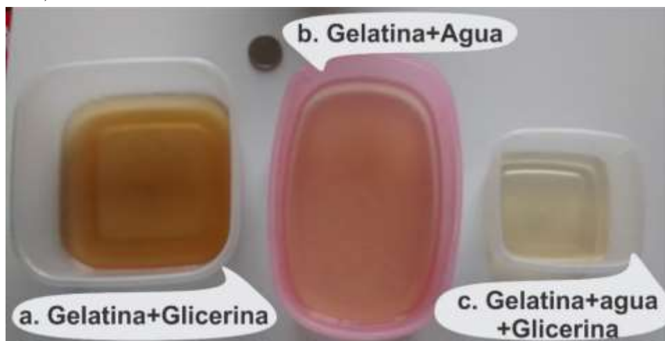
Figura 27 Muestras de gelatina con diferentes solventes que contribuyen al aumento o disminución de la viscosidad. a. Gelatina+Glicerina. b. Gelatina+agua. c. Gelatina+agua+glicerina.
