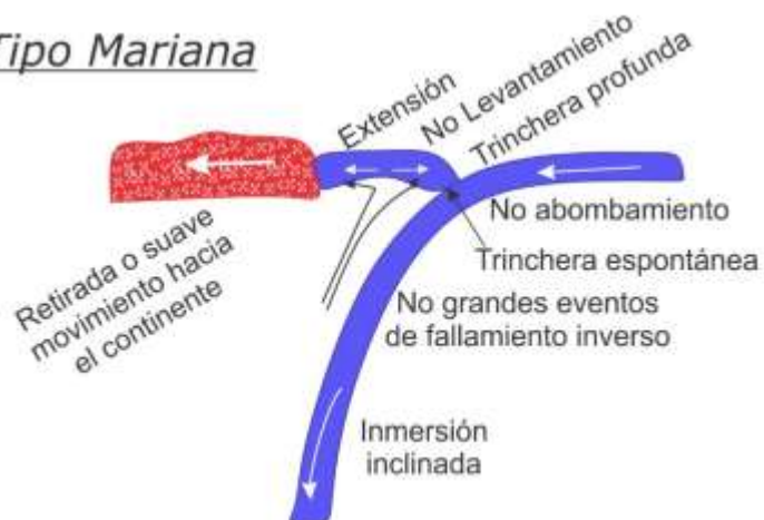
Figura 4. Dos Tipos de subducción, tipo Chile caracterizada por un bajo ángulo de subducción y grandes sismos, contrario a la tipo Mariana. Adaptado de Uyeda & Kanamori (1979)
