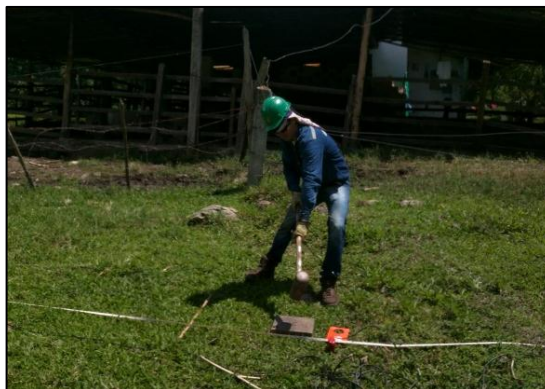
Fotografía 6. Generación de impacto mecánico con martillo de 16 Lb.
