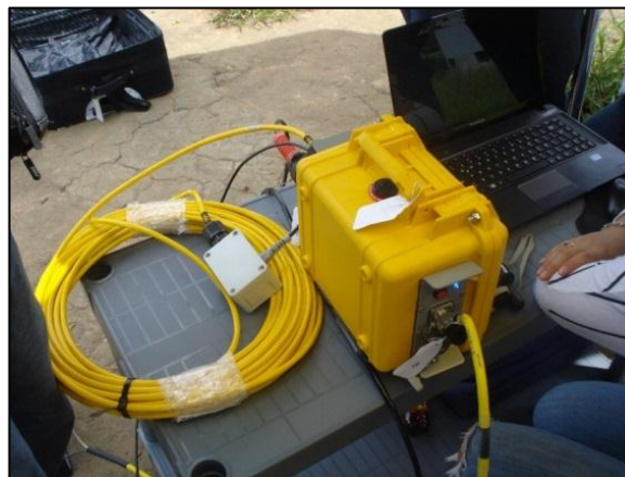
Fotografía 7. Equipo de MASW.
