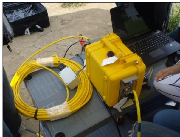
Fotografía 8. Equipo de ensayo Re-Mi.
