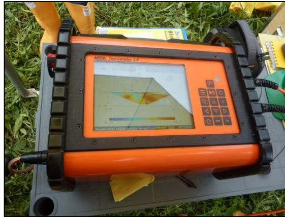
Fotografía 9. Equipo de tomografía geoelectrica.
