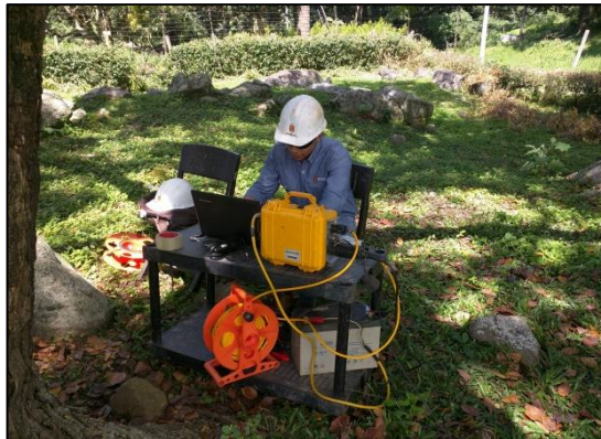
Fotografía 5. Toma de datos ensayo MASW.
