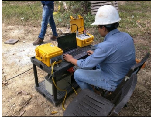
Fotografía 3. Toma de datos ensayo Down Hole
