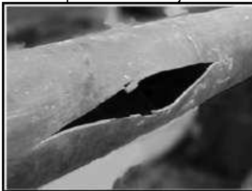
Figura 31. Fractura ocasionada por corrosión bajo tensión.
