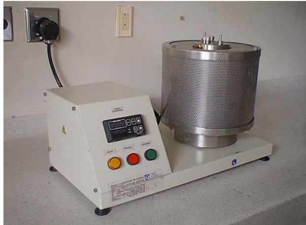
Fotografía 4. Horno de resistencia diseñado para realización de pruebas a alta temperatura.
