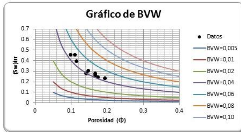
Figura 12. Gráfico de saturación de agua irreducible versus porosidad.
