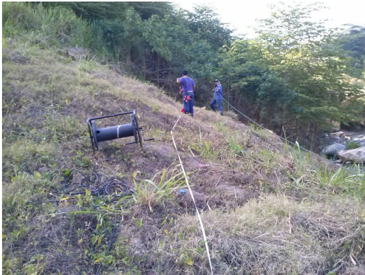
Figura 29. Línea de refracción sísmica – SIS1
