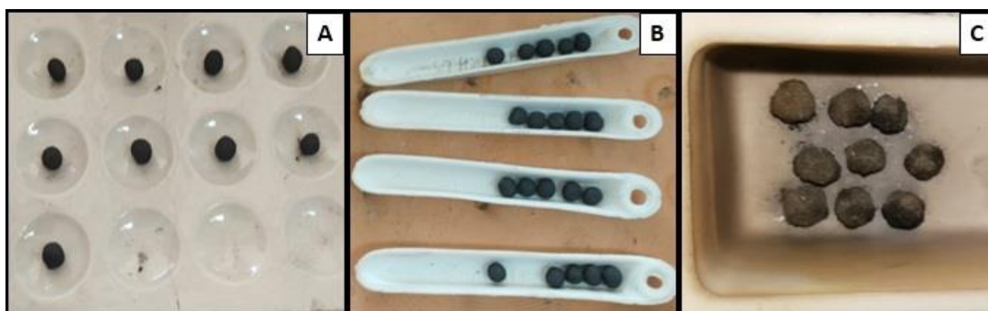
Figura 5. Cambios físicos de los pellets presentados en las etapas de (A) Mezcla en verde, (B) Secado a 100°C y (C) Reducción a 1200°C.
