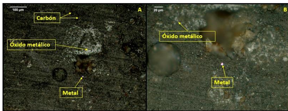
Figura 8. (A) Micrografía de muestra 2 a 1000°C, a magnificación original de 200X. (B) Micrografía de muestra 2 a 1000°C, a magnificación original de 500X.
