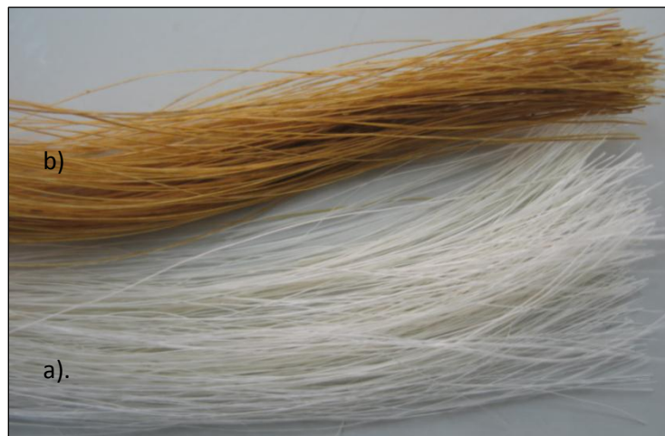
Figura 3. a) Fibras de fique limpias. b) Fibras de fique modificadas con nanopartículas de plata.
