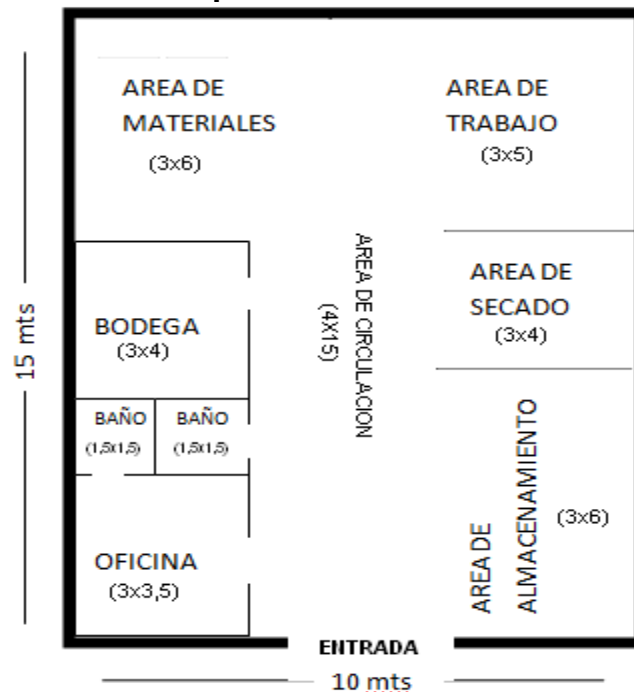
Figura 9. Distribución física planta
