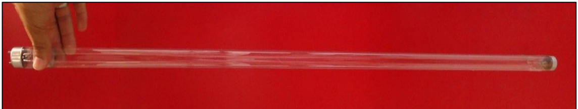
Figura 13. Lámpara empleada para generar radiación UV.
