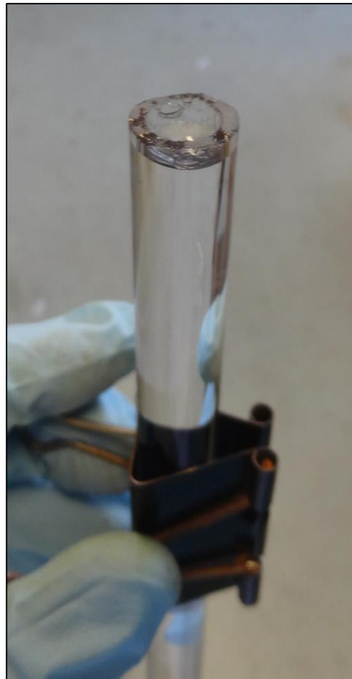
Figura 14. Tubo de cuarzo empleado como contenedor de la solución a irradiar.
