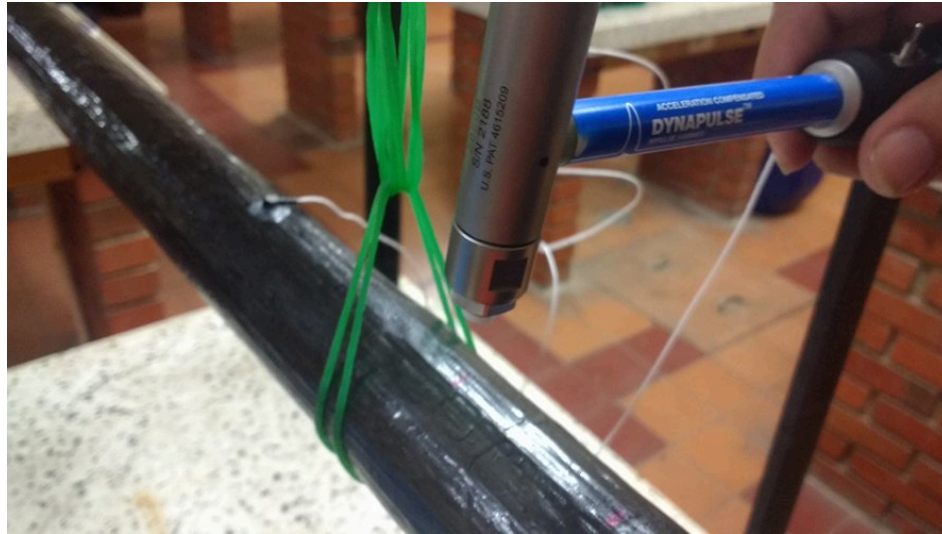
Figura 22. Adquisición de datos del análisis modal experimental
