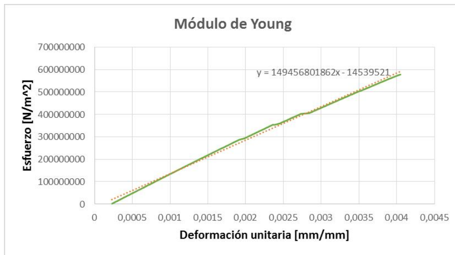
Figura 7. Zona elástica curva Esfuerzo vs Deformación probeta a 0°
