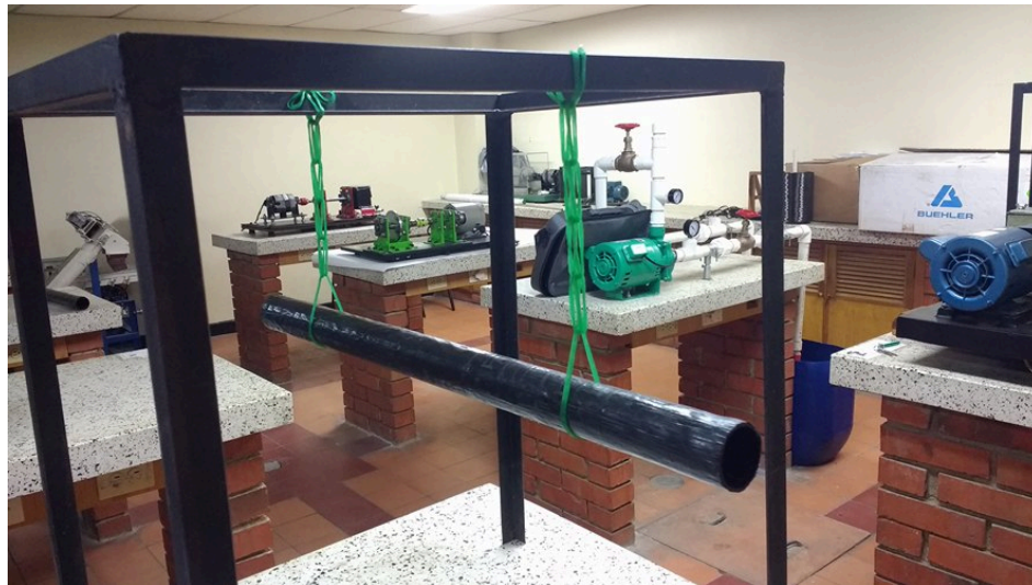
Figura 21. Montaje del prototipo para el análisis modal experimental
