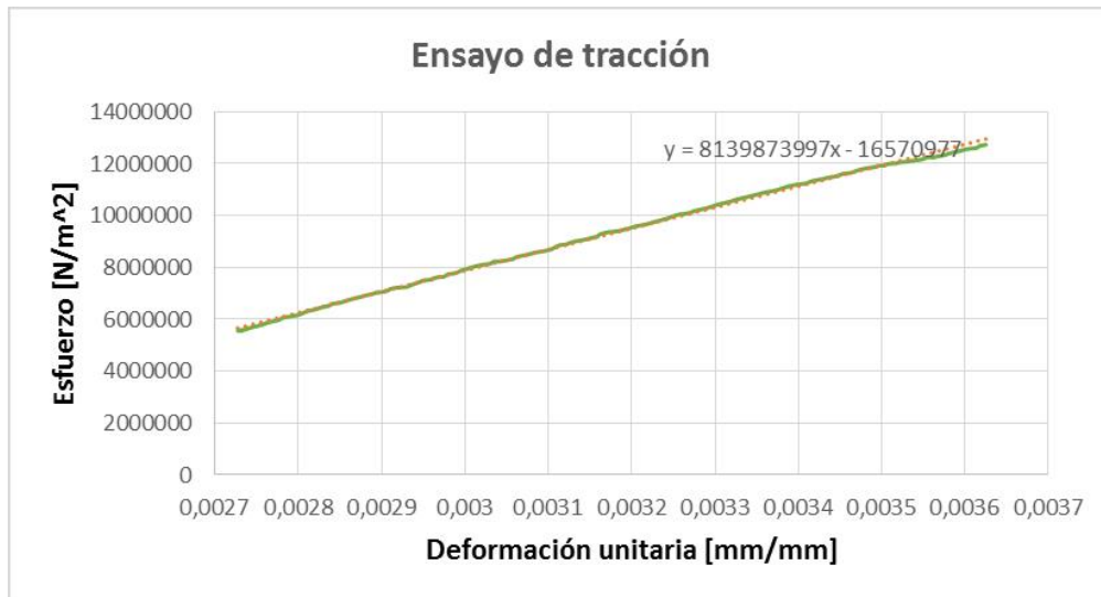
Figura 5. Curva Esfuerzo vs Deformación probeta 90°
