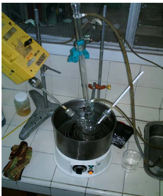
Figura 6. Montaje para la reacción de transesterificación
