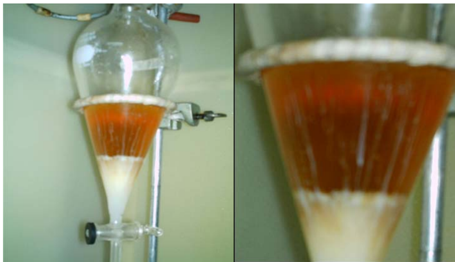
Figura 6a. Lavado; en el tope etil-ésteres, en el fondo agua de lavado.
