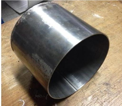
Figura 39. Tanque de restitución
