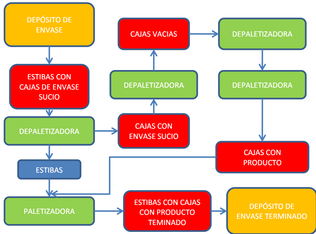
Figura 1. Diagrama de flujo correspondiente a la zona seca en un salón de embotellado.
