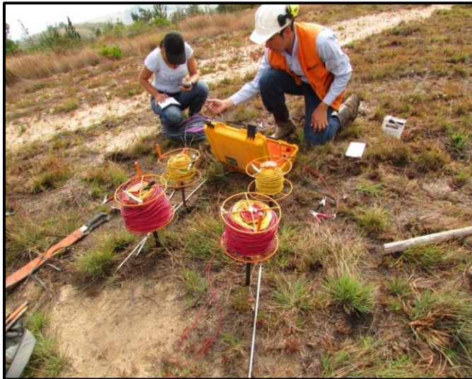
Figura 22 Montaje inicial del equipo, con la correcta disposición de los carretes.
