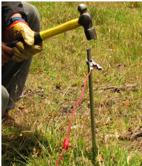
Figura 23. Montaje inicial del equipo, ubicación de los electrodos
