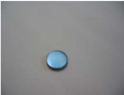
Foto 3. Ti6Al4V anodizado antes de sumergirlo en solución SBF. Condición B.
