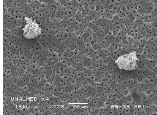
Figura 18. Micrografía de SEM para el Ti6Al4V, recubierto con fosfato de calcio después de mantenerse inmerso en solución en cada relación Ca/P (3.24, 4, 5 y 6) del SBF durante 1 hora, en un rango de temperaturas entre 24°C y 45°C. Condición W.
