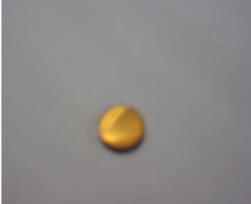
Foto 1. Ti6Al4V anodizado antes de sumergirlo en solución SBF. Condición A.
