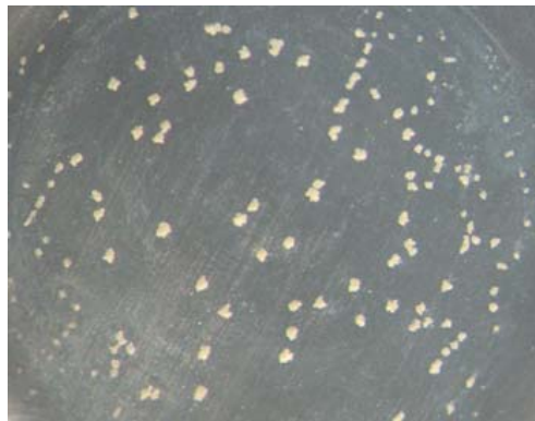
Foto 4. Ti6Al4V después de 28 días de estar inmersa en solución SBF. Condición B.
