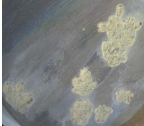
Foto 2. Ti6Al4V después de 28 días de estar inmersa en solución SBF. Condición A.
