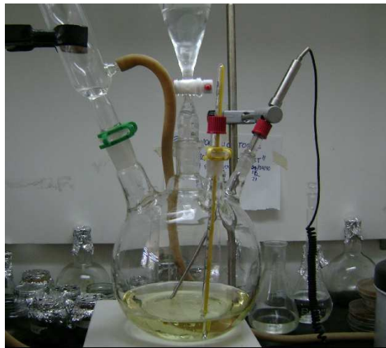
Figura 5. Montaje experimental para la producción de biodiesel a partir de aceite sintético de Chlorella Vulgaris
