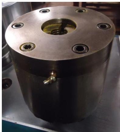
Figura 64. Accionadores de las mordazas hidráulicas
