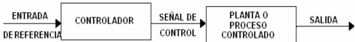
Figura 94. Diagrama de bloques del sistema de control en lazo abierto
