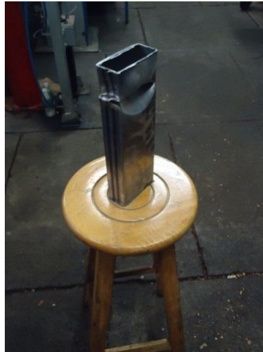
Figura 84. Falla de la Columna de Acero
