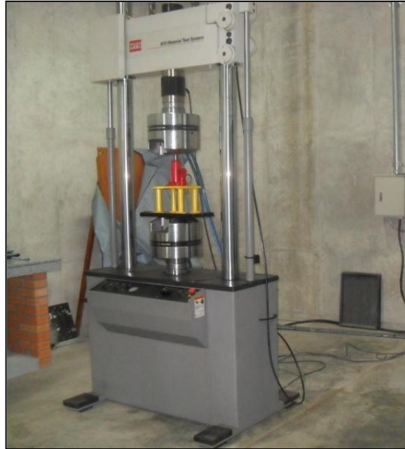
Figura 52. Montaje del verificador en el ensayo
