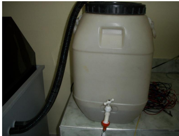
Figura 67. Deposito de solución salina
