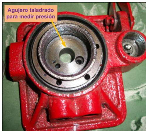
Figura 43. Base taladrada del gato hidráulico de botella
