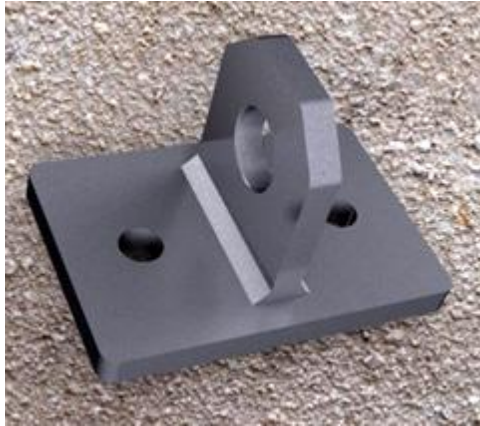
Figura 5. CAD conector de anclaje diseñado
