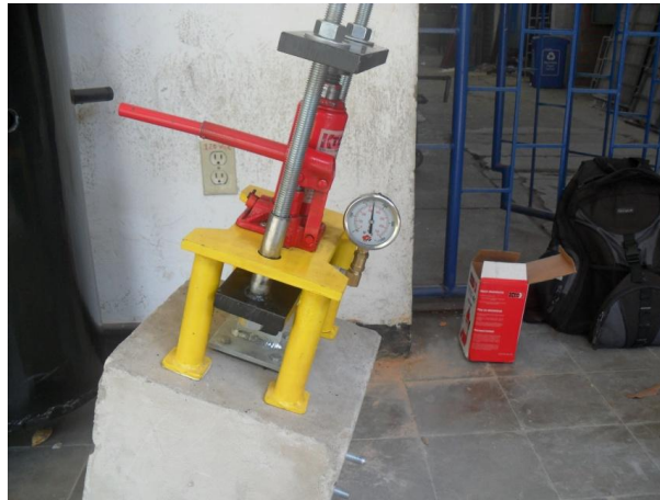
Figura 57. Prueba de extracción del equipo verificador
