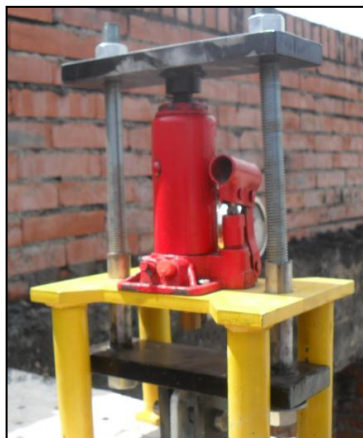
Figura 72. Verificador de conector de anclaje
