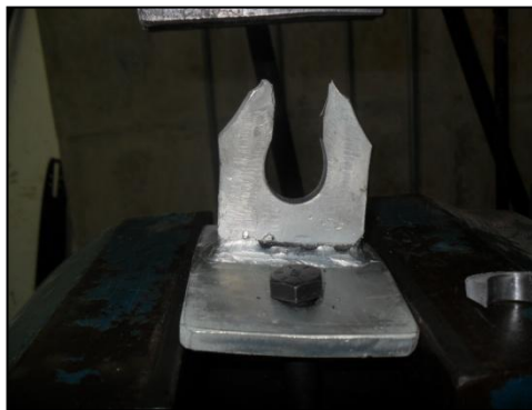
Figura 60. Falla por rotura del conector de anclaje
