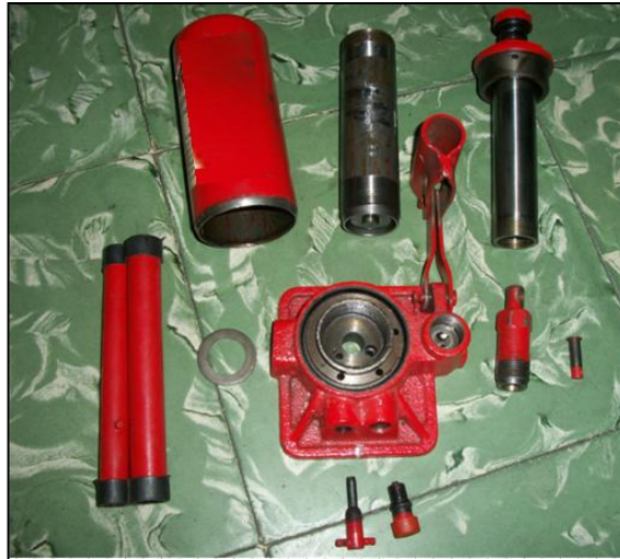
Figura 42. Desarme del gato hidráulico de botella
