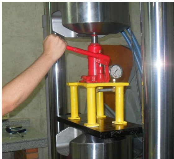
Figura 54. Prueba de calibración del verificador
