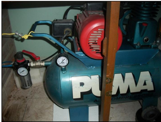
Figura 66. Equipo de suministro de aire
