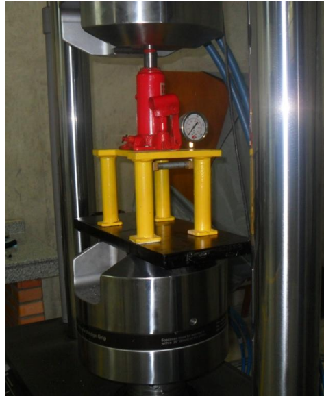
Figura 53. Montaje del verificador en el ensayo lateral
