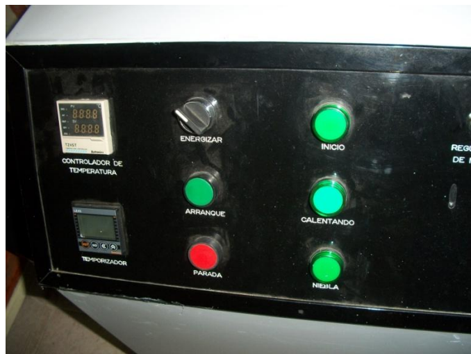
Figura 65. Panel de control de la cámara de niebla
