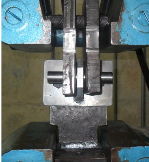
Figura 61. Montaje conector de anclaje para pruebas a corte.
