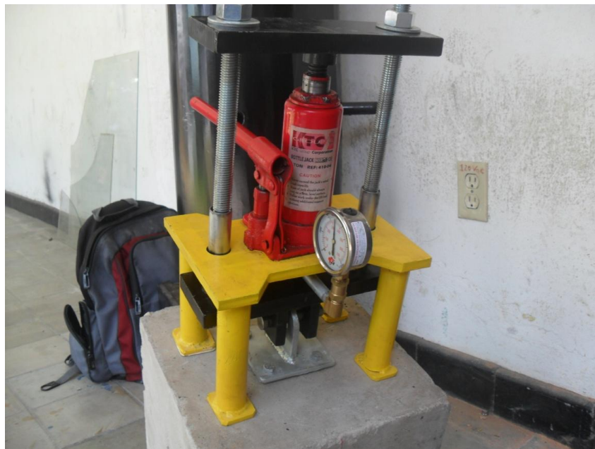
Figura 58. Prueba de extracción del equipo verificador lateral
