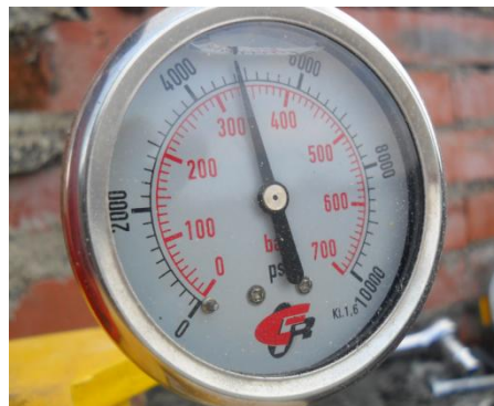
Figura 75. Manómetro registrando la carga aplicada.
