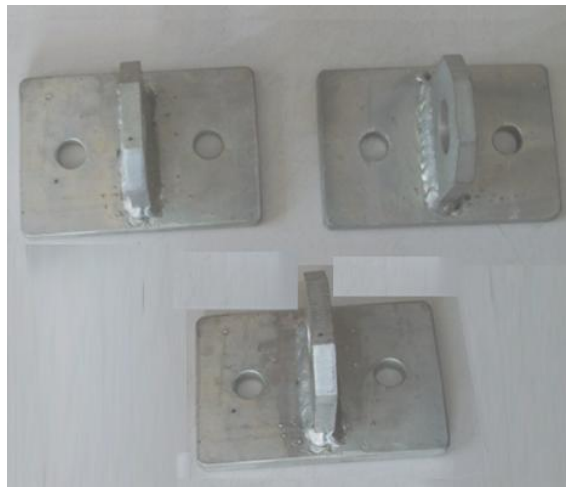
Figura 68. Muestras sometidas al ensayo de corrosión.
