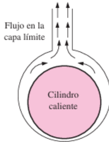
Figura 1. Flujo por convección natural en cilindro horizontal caliente
