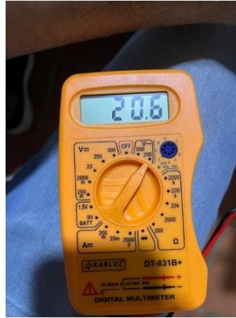
Figura 20. Medición de voltaje del montaje a través de multímetro
