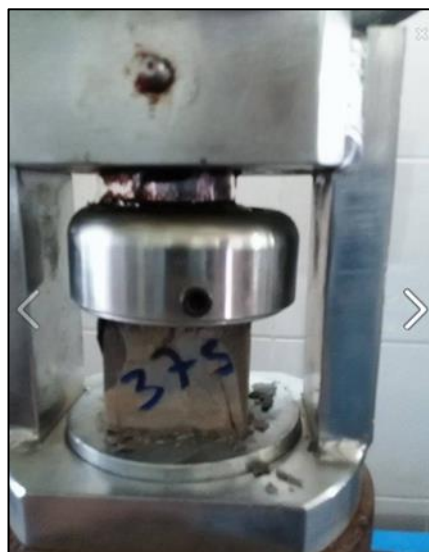
Figura 18. Ensayo a compresión de cubo de lechada.
