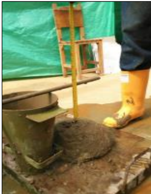
Figura 23. Medición del asentamiento
