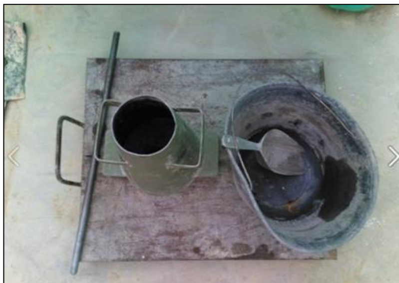
Figura 22. Equipo necesario para la toma de asentamiento
