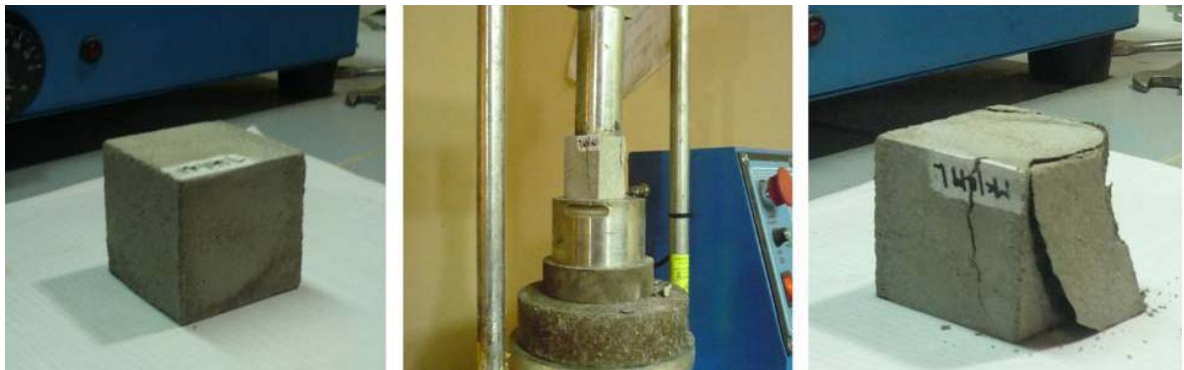
FIGURA 38. Antes y después de la compresión del mortero MK149L y con una resistencia de 20,04Mpa.
