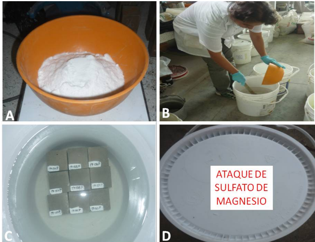
FIGURA 12. Proceso realizado para el ataque de sulfato. A. Cantidad de gramos de sulfato previamente calculados. B. Preparación y disolución de Sulfato y agua. C. Después de disolver la mezcla se agregan los cubos después de 24 horas y seguidamente ser tapados (E).
