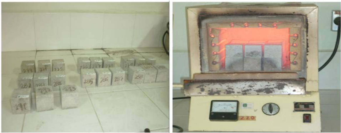
FIGURA 13. Morteros que fueron llevados al horno con temperaturas de 300°C, 600°C, 1000°C.
