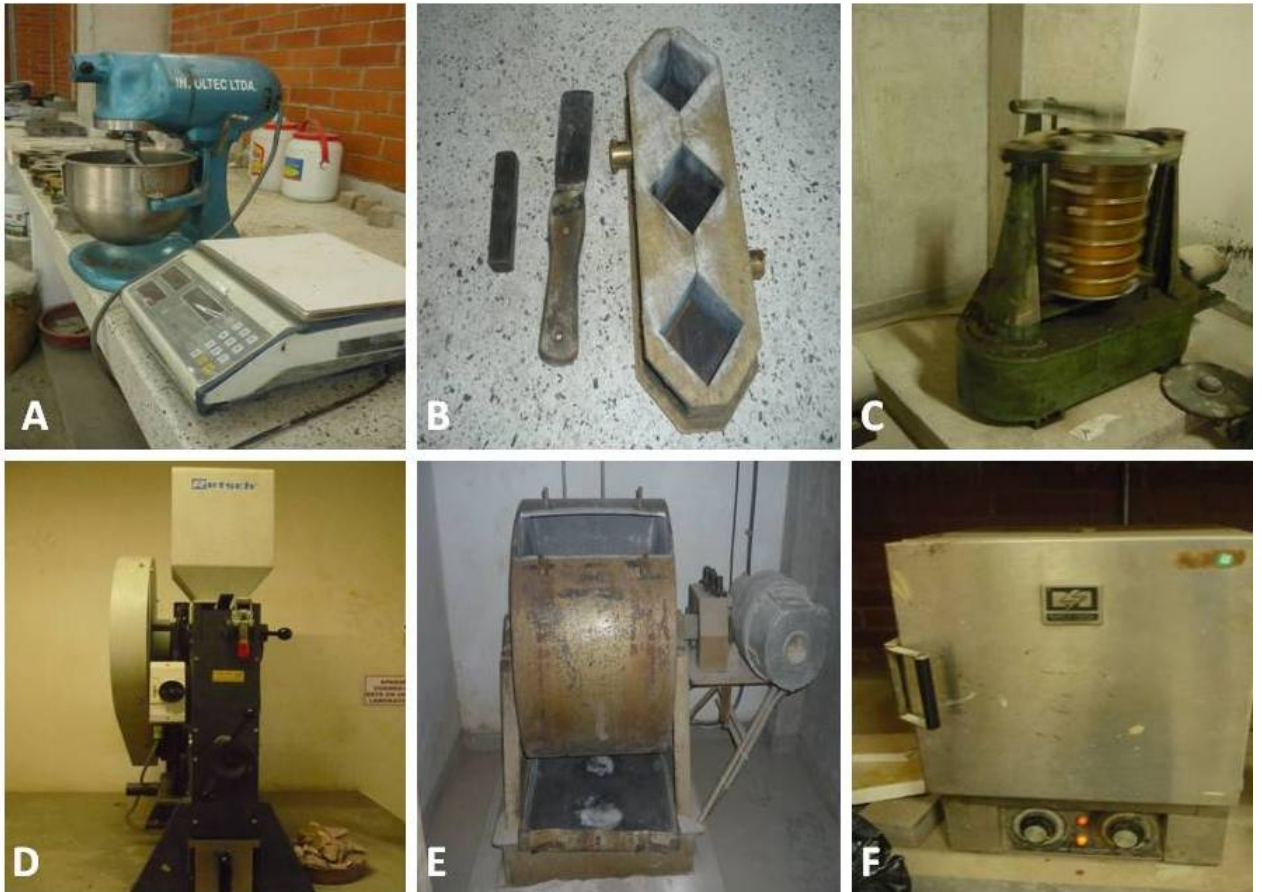
FIGURA 5. Materiales utilizados. A. Mezcladora mecánica y la balanza requeridas por las normas técnicas Colombianas NTC. B, Moldes utilizados para la elaboración de los morteros, compactador de madera y espátula. C. Tamizador mecánico y tamices. D Y E Trituradoras mecánicas. F. Mufla.
