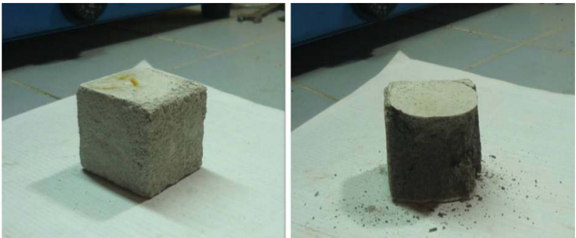
FIGURA 47. Mortero.MK106P. Antes y después de la compactación, registró una resistencia de 18,95 MPa.
