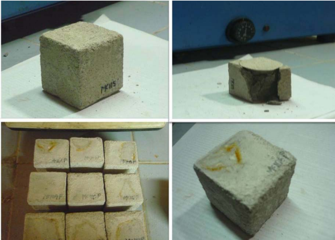
FIGURA 45. Proceso realizado para compresión de ataque de acido. A y B Antes y después de la compactación de mortero MK115L. C y D. Manchas presentadas después del ataque de acido sulfúrico a los morteros.
