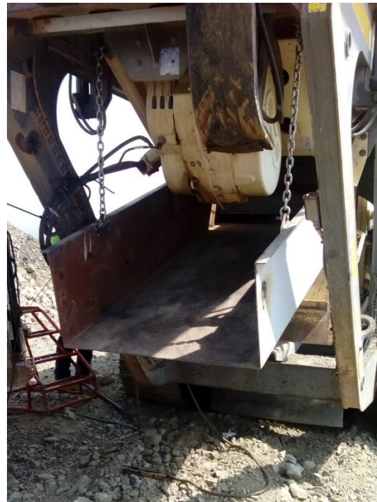
Figura 73. Adición de canal a la trituradora.
