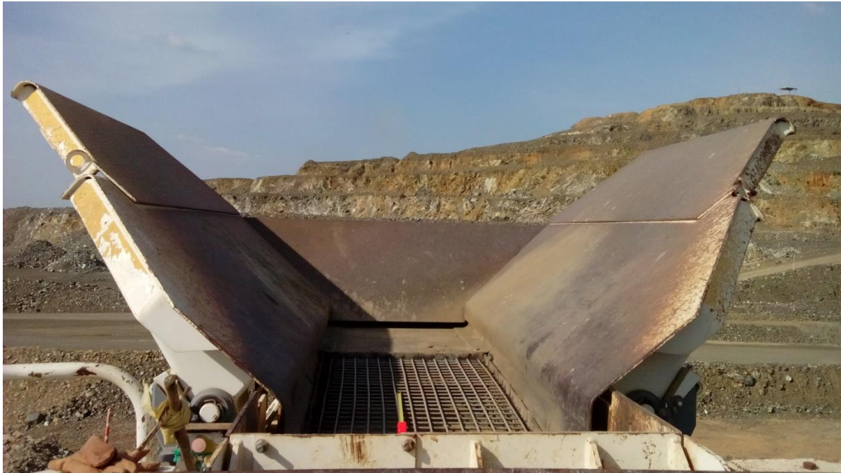
Figura 74. Malla instalada en la trituradora, con una apertura de 50mm
