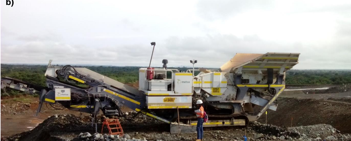
Figura 80. a) Trituradora dispuesta con dos salidas o bandas. b) Trituradora dispuesta con 3 salidas de material (2 bandas y 1 canal).
