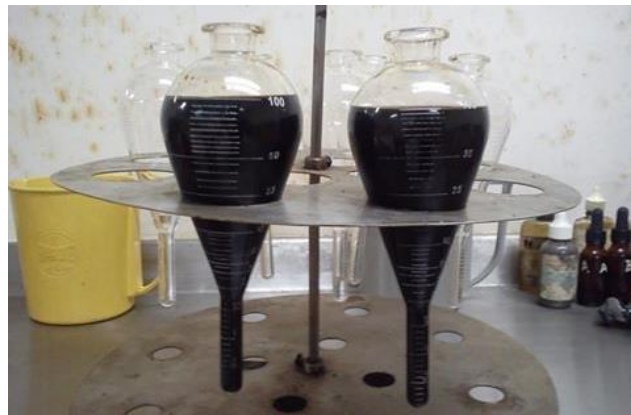
Figura 16. Prueba BS&W para el crudo de tanque del campo colorado.
