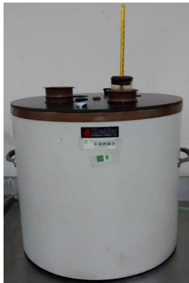
Equipo para medición de punto de fluidez. Laboratorio de fluidos, Escuela Ingeniería de Petróleos – UIS.
