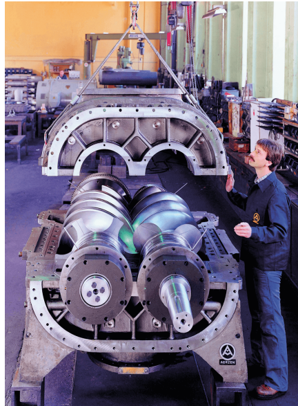
Figura 56. Compresor tornillo rotatorio. Adaptada de Aerzen. Disponible en: https://www.aerzen.com/es/empresa/perfil/hitos.html?tx_cookies_main%5Baction%5D=su bmit&cHash=12e7178d8c922cfd35ad03f7f15d5230
