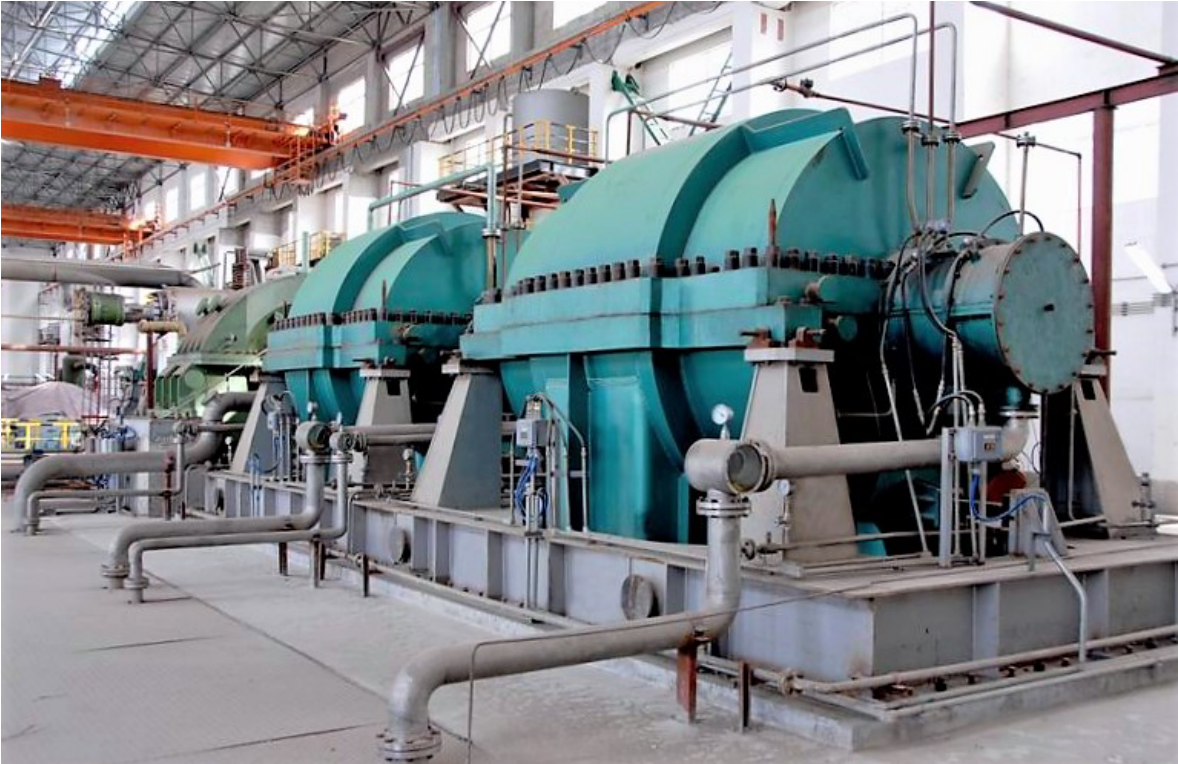
Figura 61. Carcasa dividida horizontalmente de un compresor centrífugo. Adaptada de Machinery Study Disponible en: http://machinerystudy.blogspot.com/2015/03/centrifugal-compressor.html
