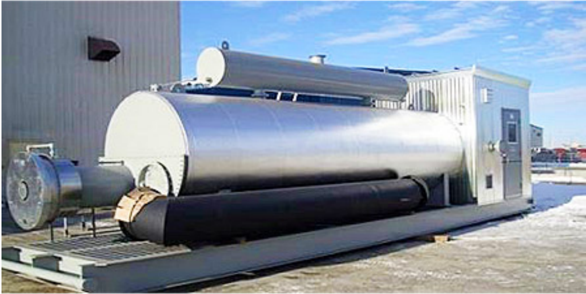
Figura 124. Calentador indirecto. Adaptado de Napeec. Disponible en: http://www.napeec.com/Napeec%20Brochures/Indirect%20fired%20heater.pdf
