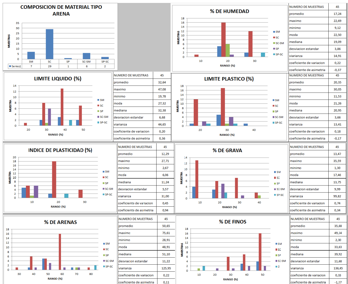
Figura 114. Resultado de los ensayos de clasificación, límites de consistencia, humedad y granulometría para 261 muestras recolectadas hasta una profundidad de exploración de 25 m, donde se analizan los suelos arenosos encontrados.
