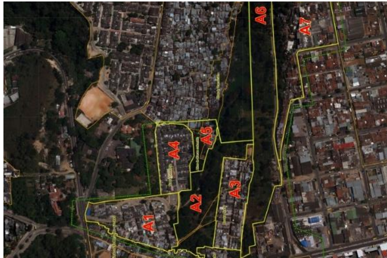
Figura 38. Áreas Aferentes de Escorrentía
