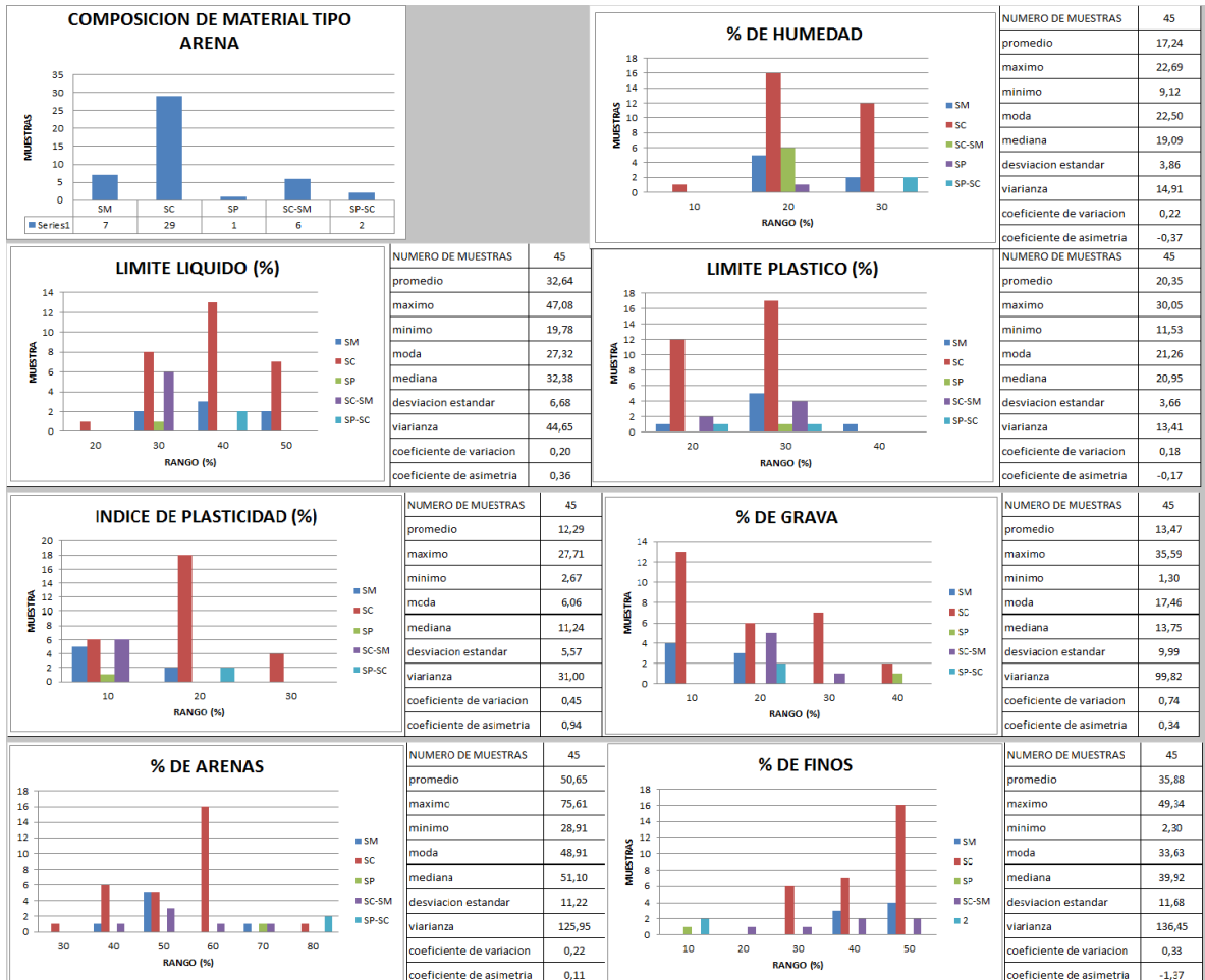
Figura 115. Resultado de los ensayos de clasificación, límites de consistencia, humedad y granulometría para 24 muestras recolectadas hasta una profundidad de exploración de 25 m, donde se analizan los suelos gravosos encontrados.
