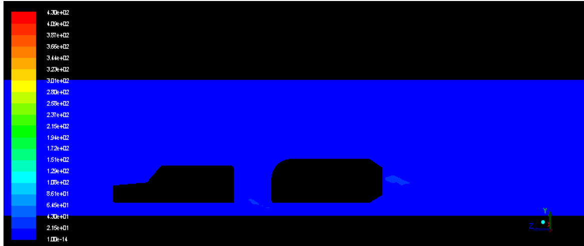
Figura 106. Turbulencia de remolque acoplado
