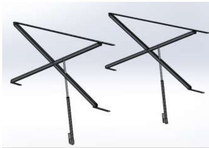
Figura 60. Modelado del mecanismo de techo levadizo
