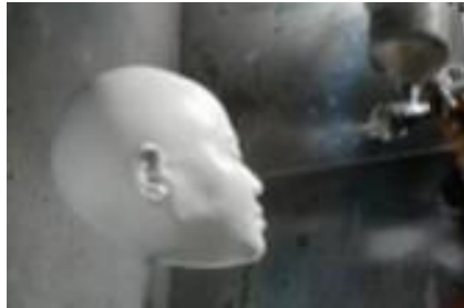
Figura 35. Aplicación de pintura blanca con aerógrafo
