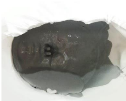
Figura 25. Vaciado de plasticera en molde de alginato
