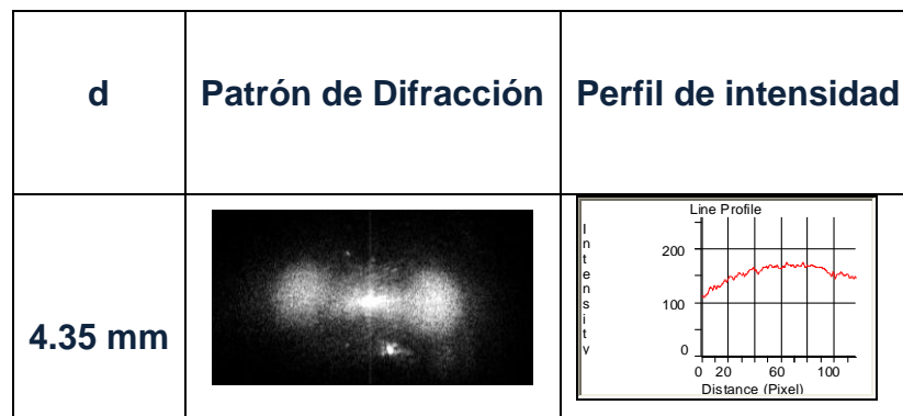
Figura 4.8: Órdenes difractados para separación de abertura d=4.35 , en geometría de reconstrucción fija y perfil de intensidad correspondiente a uno de los órdenes laterales. Dimensiones del Cristal 10 \times 10 \times 10 mm, Z_c=440 mm, D=2.65 mm, E_{ext} = 7 Kv
