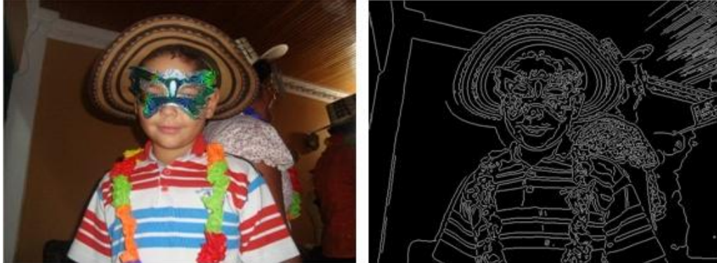
Figura 14 Aplicación del filtro Canny: (A) Image original. (B) Aplicación del filtro Canny.
