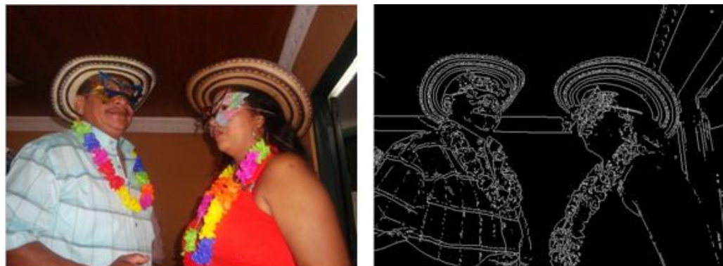
Figura 10 Aplicación del gradiente de Prewitt: (A) Imagen original. (B) Imagen después de Aplicar el gradiente de Prewitt.
