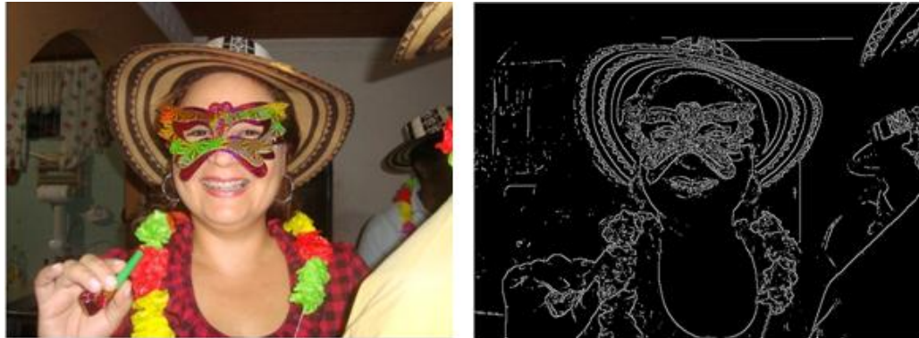
Figura 9 Aplicación del gradiente de Robert: (A) Imagen original. (B) Imagen después de Aplicar el gradiente de Robert.
